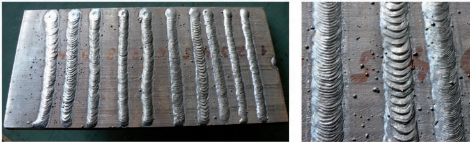
Fig.B aspetto del cordone fatto con elettrodo cellulosico
